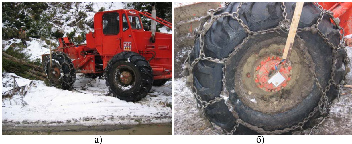
Рис. 2. Спеціальні сталеві протиковзальні ланцюги на тракторі ТАФ-658
