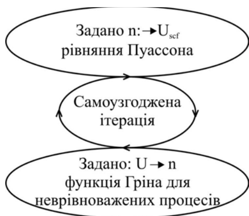
Рис. 2. Метод ітерації для узгодження ФГНП з рівнянням Пуассона
