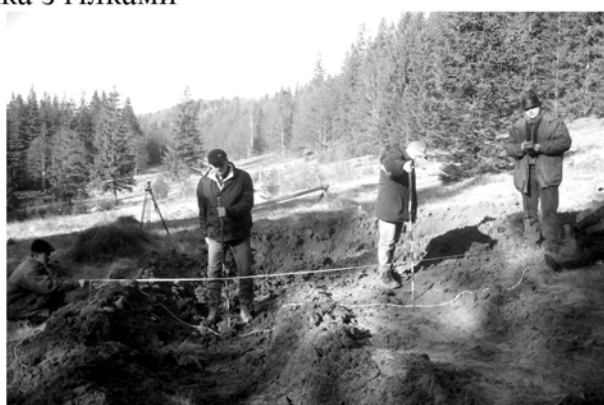
Рис. 12. Дослідження взаємодії трелювальних тракторів ЛКТ-81 (зліва) та ТДТ-55 (справа) з опорною поверхнею (15-й проїзд трактора)
