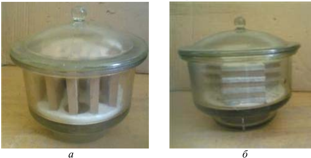
Рис. 1. Розташування зразків вільхи в ексикаторі для: а – визначення коефіцієнта вологопровідності; б – вологості межі гігроскопічності
