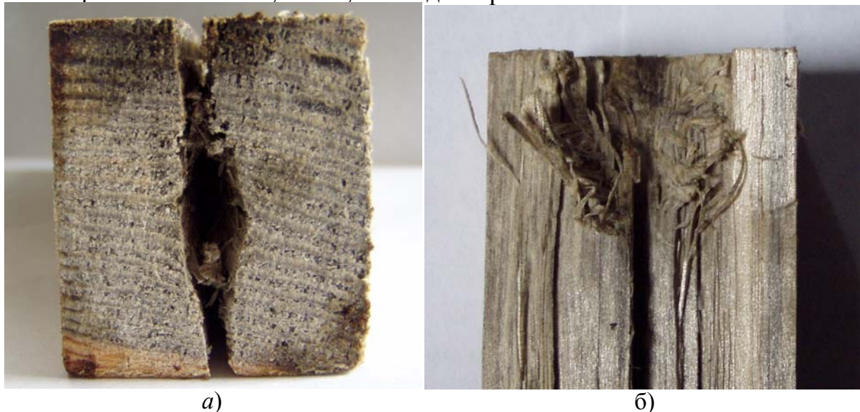
Рис. 6. Деформації деревини, які виникають при заглибленні виступаючого зуба в деревину
