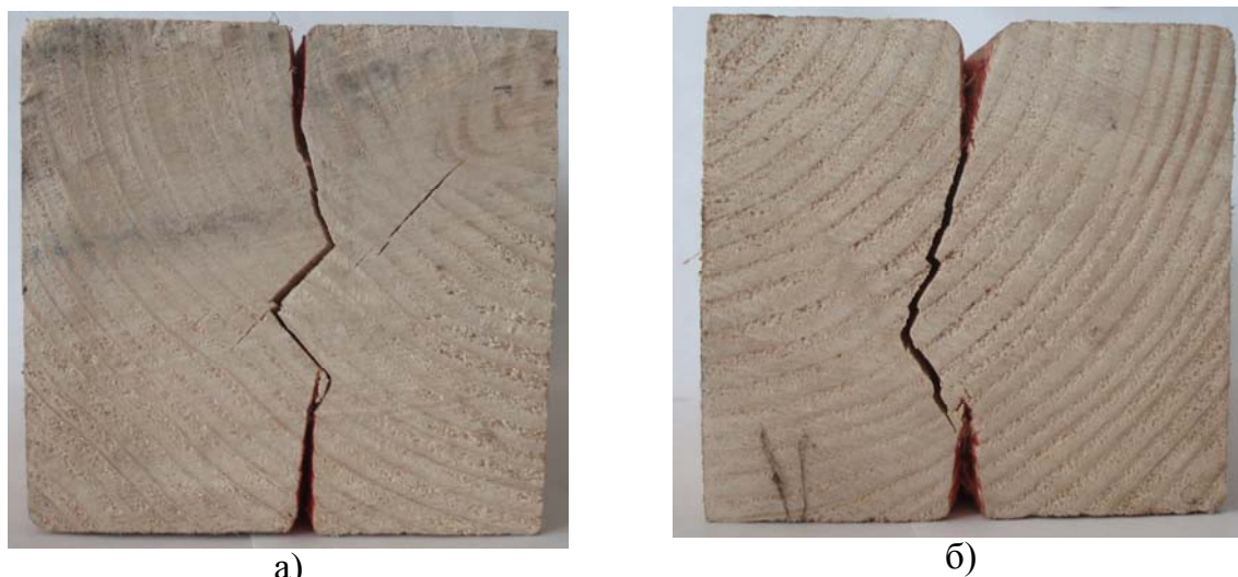
Рис. 4. Шлях поширення тріщини при розколюванні робочим органом з ламаним лезом
