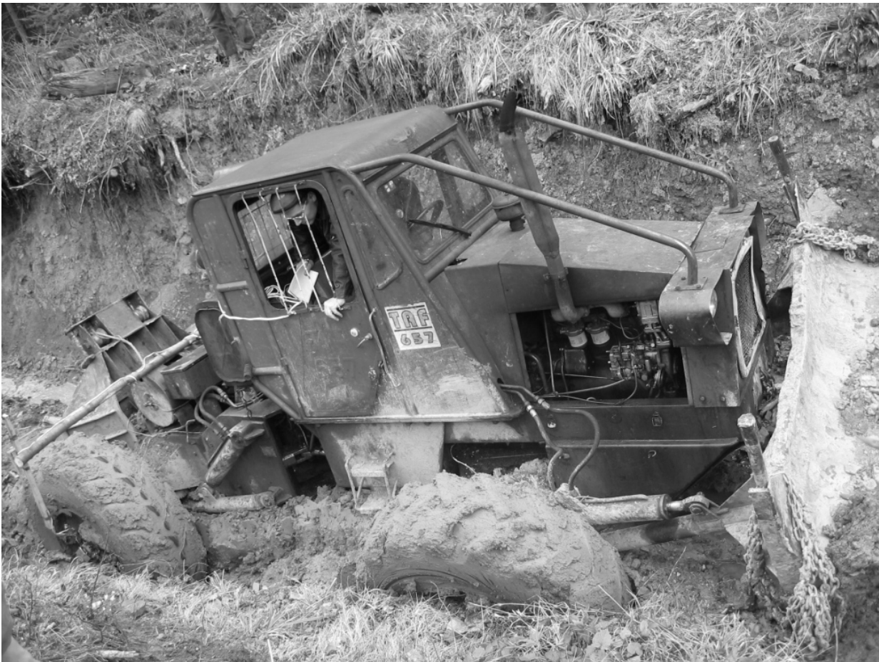
Рис. 1. Втрата можливості руху колісного трелювального трактора (фото О. Стиранівський)
