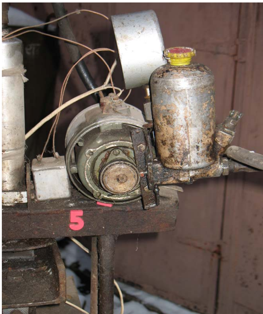
Рис. 1. Стенд для випробування плунжерної пари під тиском
