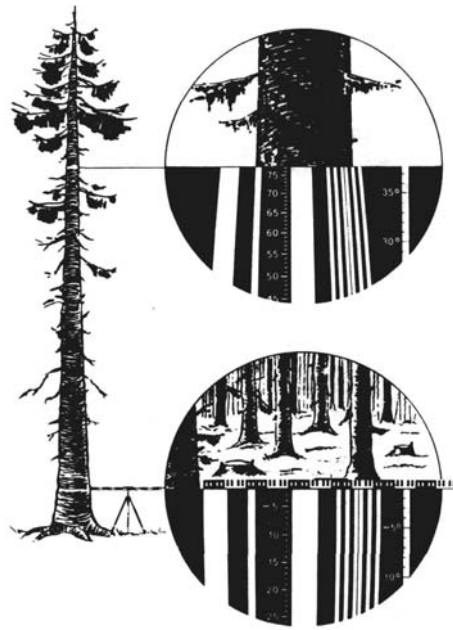
Рис. 5. Вимірювання діаметрів та висот телереласкопом
