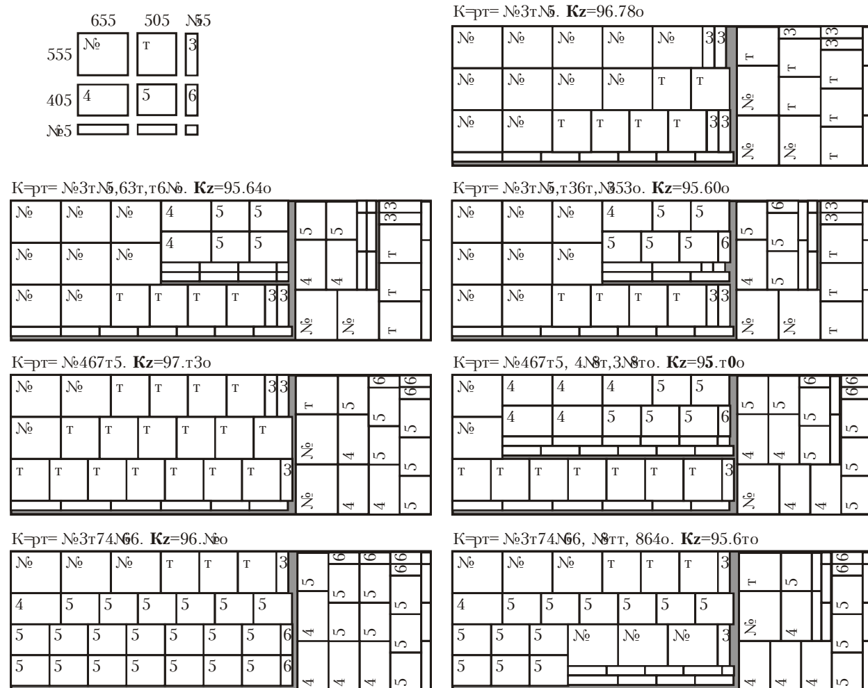
Рис. 4. Карти розміщення ПО у межах торцевої та основної частин ПП з застосуванням вкладених карт розміщення ПО (розміри ПП: 5500×1830 мм; площа ПП: 10.065 м 2 ; МШТЧ ПП: 1830 мм)
