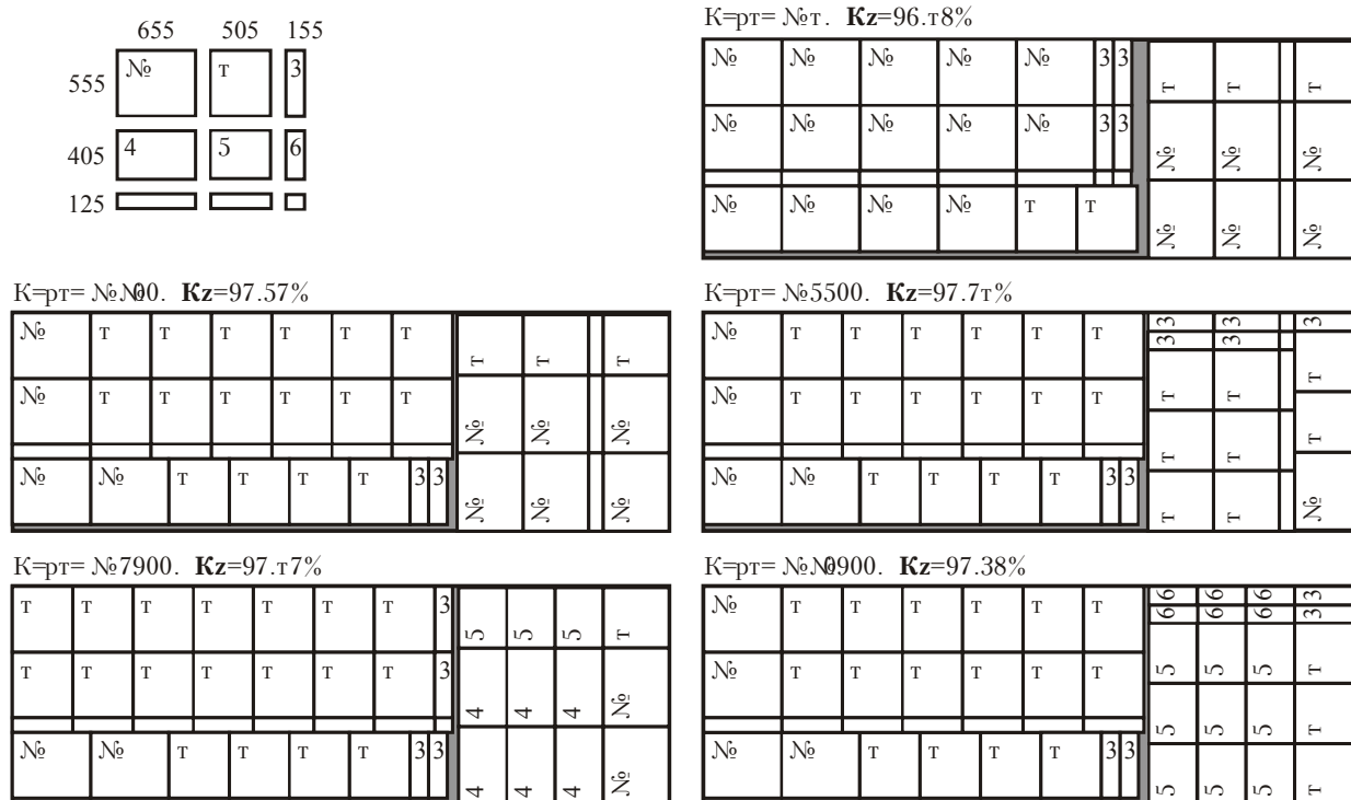
Рис. 3. Варіанти карт розміщення ПО у межах головної та основної частин ПП з комбінацією двох "сіток" (розміри ПП: 5500×1830 мм; довжина головної частини: 1830 мм; НШД частин ПП: 1220 ±100 , 610 ±0 мм)
