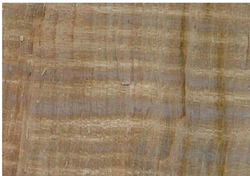
Рис. 2. Деревина явора із хвилястою звилкуватістю
