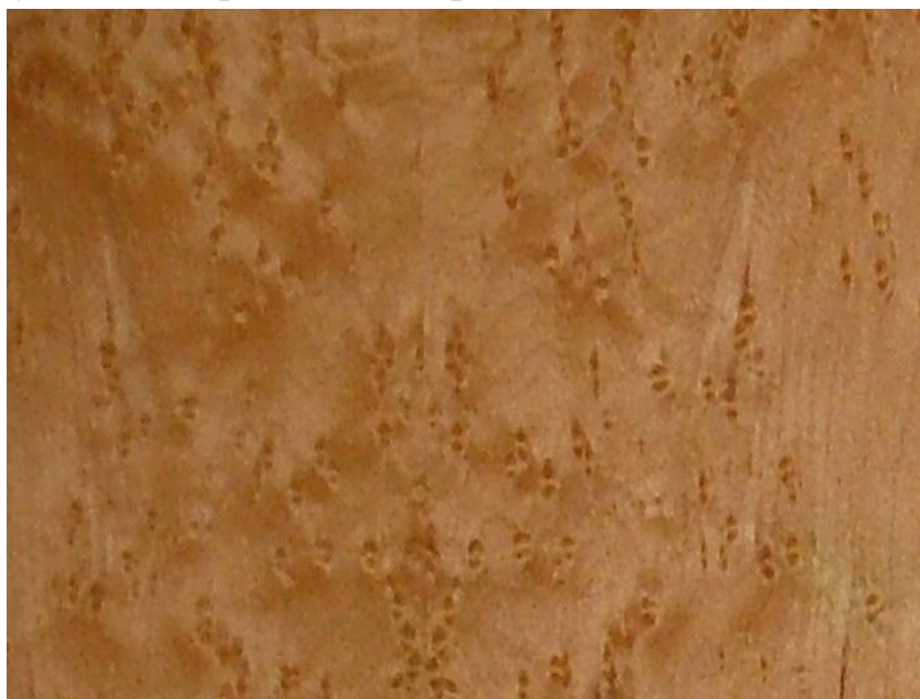
Рис. 1. Деревина явора "Пташине око"
