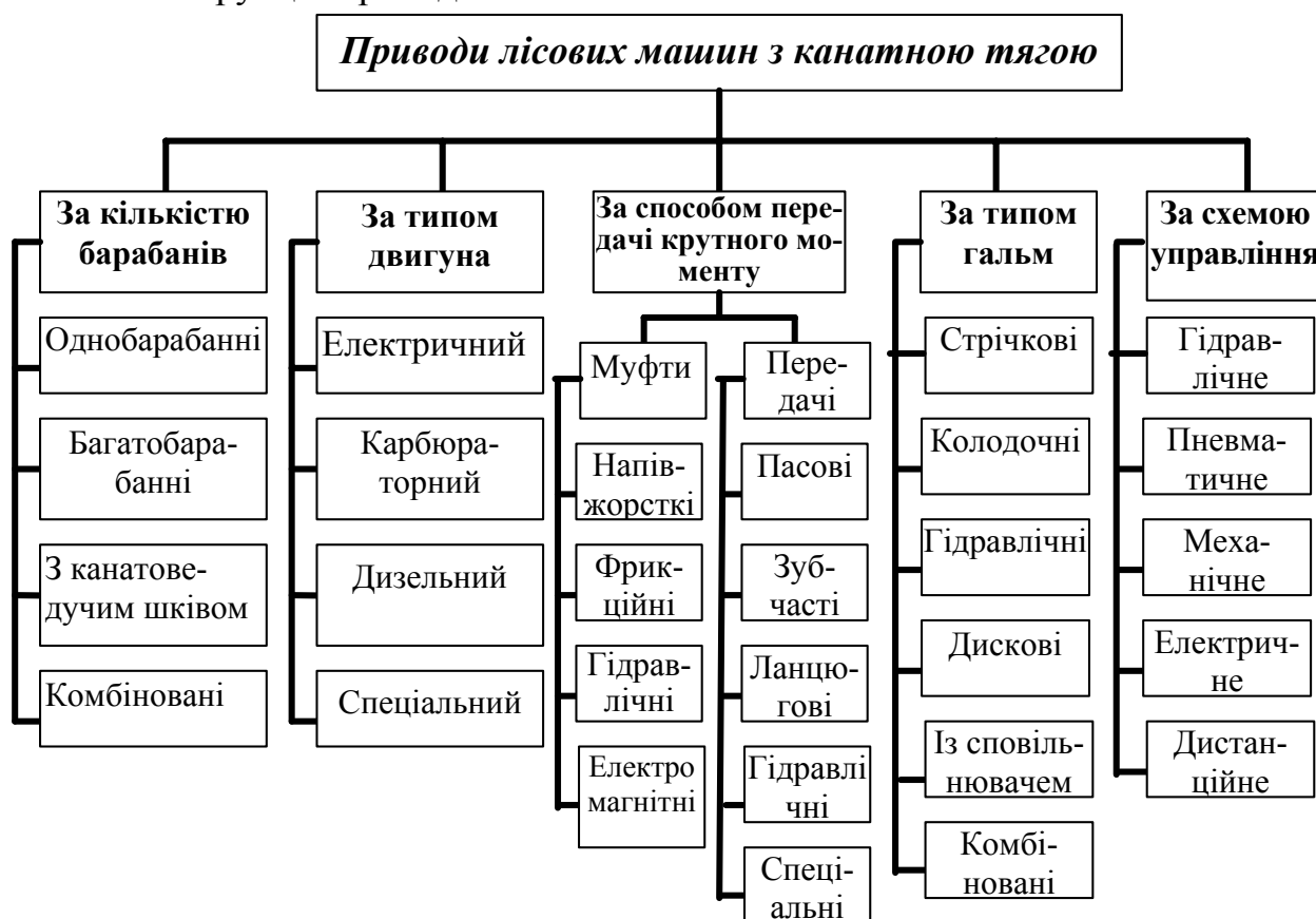
Рис. 4. Схема класифікації приводів лісових машин з канатною тягою
