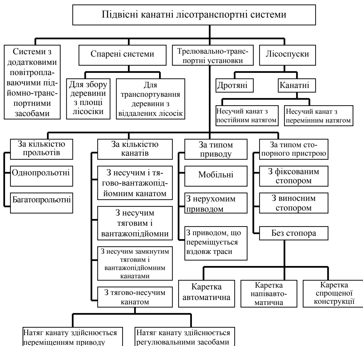
Рис. 2. Схема класифікації підвісних канатних лісотransпортних систем
