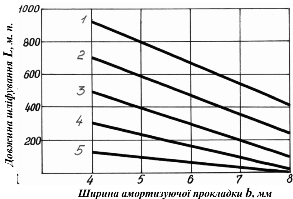
Рис. 6. Залежність довжини шліфування L від ширини пружної вставки b : 1 - z = 8 ; 2 - z = 12 ; 3 - z = 16 ; 4 - z = 20 ; 5 - z = 25 . n = 18 ; V_B = 10\% ; V_{зep} = 42\%
