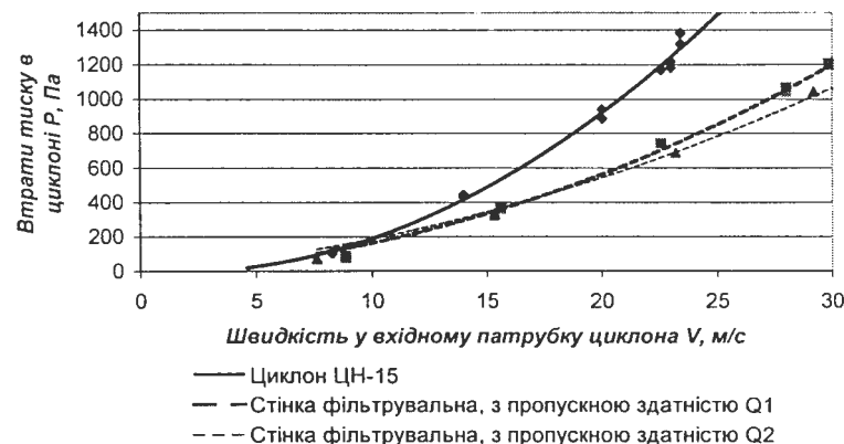
Рис. 2. Аеродинамічні характеристики циклона та фільтруючих циклонів
