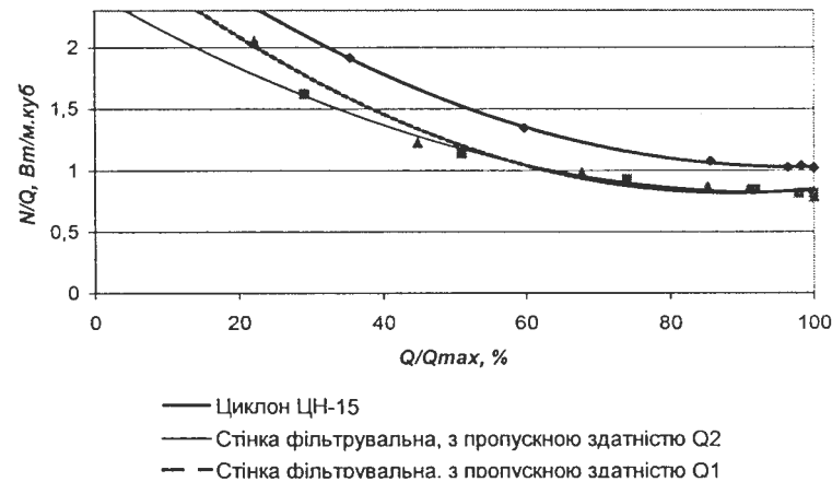
Рис. 3. Графік залежності питомої споживаної потужності вентилятора від завантаження циклона ( N - споживана потужність електродвигуна вентилятора; Q - витрати повітря)
